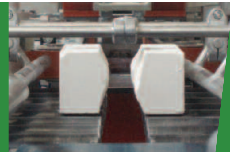
2. Schritt: Beide Steinhälften werden bossiert.
